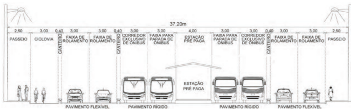
IMAGEM 52 - Seção Tipo com Estação Pré Paga. FONTE: PMF, 2016.
