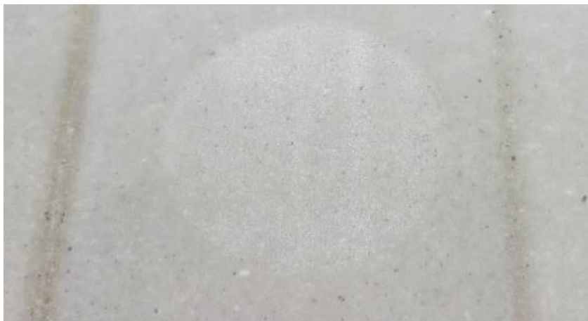
Figura 30. Ataque químico C, descaracterização do desenho e perda de brilho.
