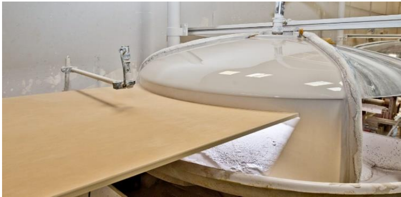
Figura 12. Aplicação por campana
