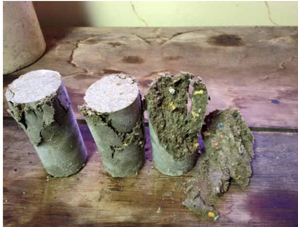
Figura 4: Corpo de Prova Rompido. Fonte: elaborada pelos autores.
