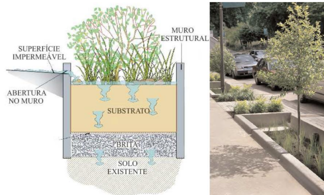
Figura 03: esquema de um canteiro pluvial com infiltração.
