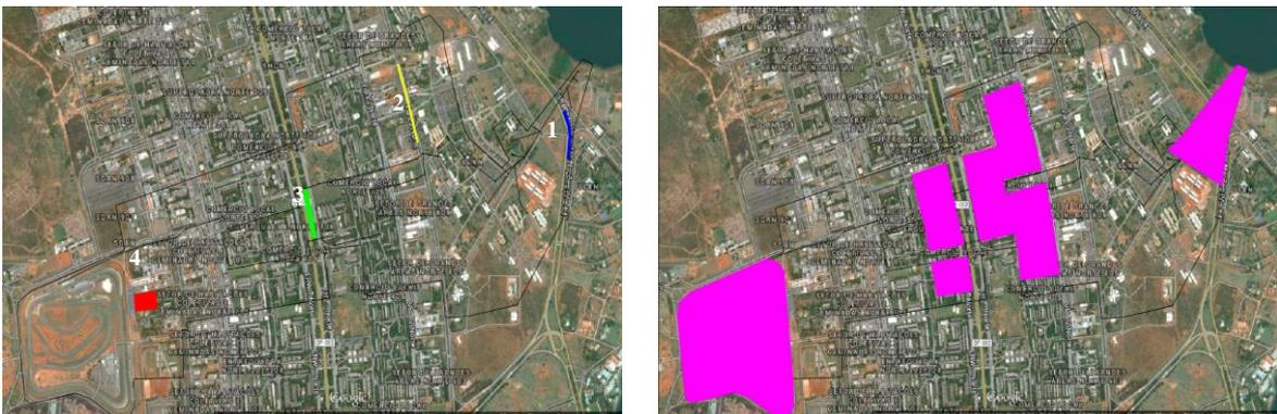
**Figura 4 – Na foto à esquerda temos a localização das bacias de retenção do estudo. Na foto à direita a localização das trincheiras de infiltração. Fonte: Maldy, Mendes e Koide (2015)**
