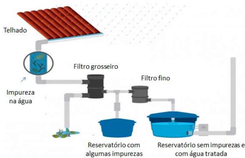
Figura 2: Esquema de coleta água da chuva. Fonte: Adaptado de IPT (2015).
