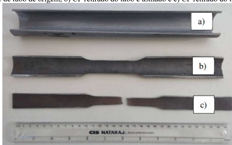
Figura 6 – Corpo de prova (CP) retirado do tubo para ensaio mecânico de tração em tubos de aço carbono. a) Corte de parte de tubo de origem, b) CP retirado do tubo e usinado e c) CP retirado do tubo após ensaio
