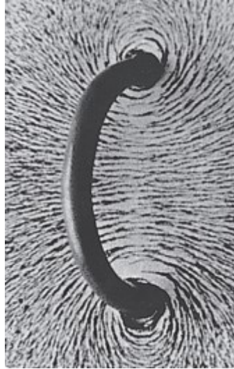
Figura 20. Linhas de campo magnético de uma espira circular com corrente indicadas por limalha de ferro (TIPLER; MOSCA, 2006).
