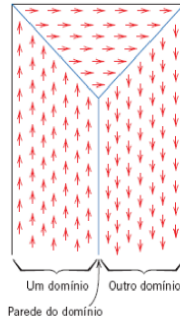
Figura 12. Representação esquemática de domínios em um material ferromagnético ou ferrimagnético (CALLISTER, 2016).
