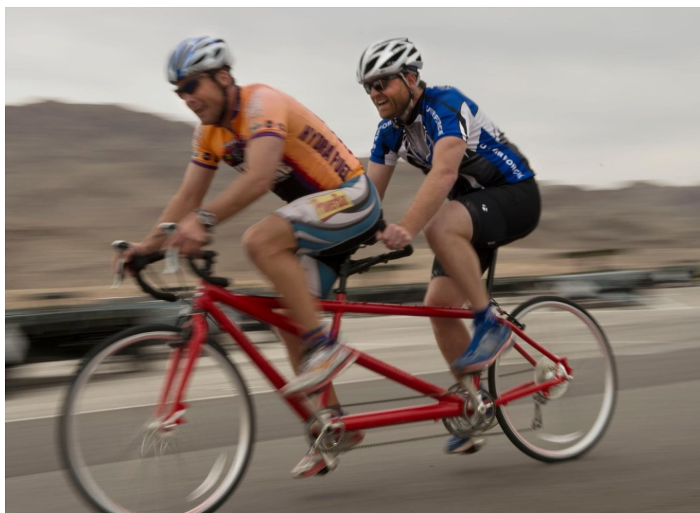
Figura 1. bicicleta tandem, é possível observar os guidões, pedivelas e selins, e como os ciclistas estão posicionados (Fonte: google.com)
