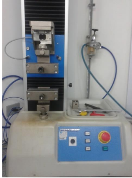
Figura 11 – Dinamômetro utilizado para o ensaio de tração
