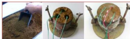
Figura 6. Preparação da amostra com os tensiômetros de medida indireta.
