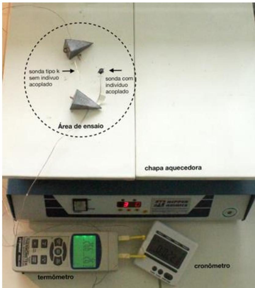
Figura 9. 4. Equipamento utilizado no experimento: chapa aquecedora, termômetro, cronômetro, sonda do tipo K.
