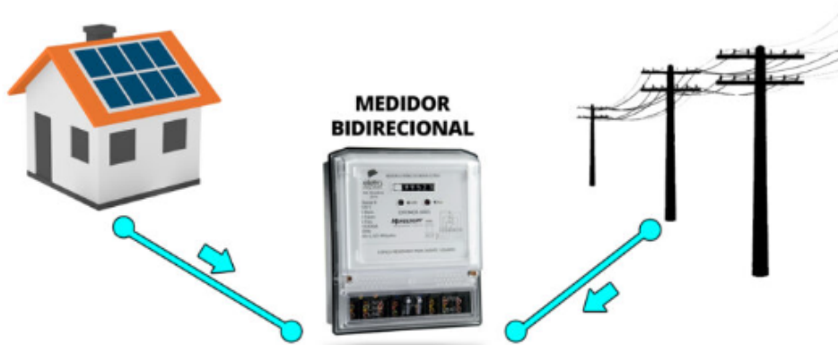
Figura 7 – Medidor Bidirecional de Energia.
