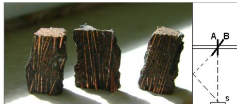
Figura 10: Orientação das FOP no interior da matriz cimentícia e sua influência na transmitância. Fonte: elaborado pelos autores.
