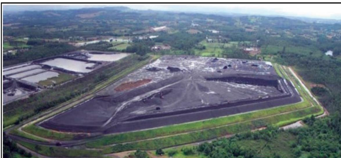
**Fonte:** Vista superior de um módulo de rejeitos da Carbonífera Criciúma S.A (centro) e as bacias de sedimentação do tratamento da água de processo (esquerda). Amaral Filho et al., 2013.
