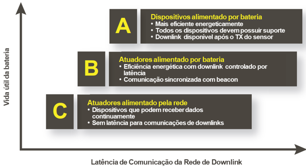
Figura 18 - Comparação entre vida útil da bateria e latência da comunicação de downlink do servidor entre as classes de dispositivos do protocolo LoRa.
