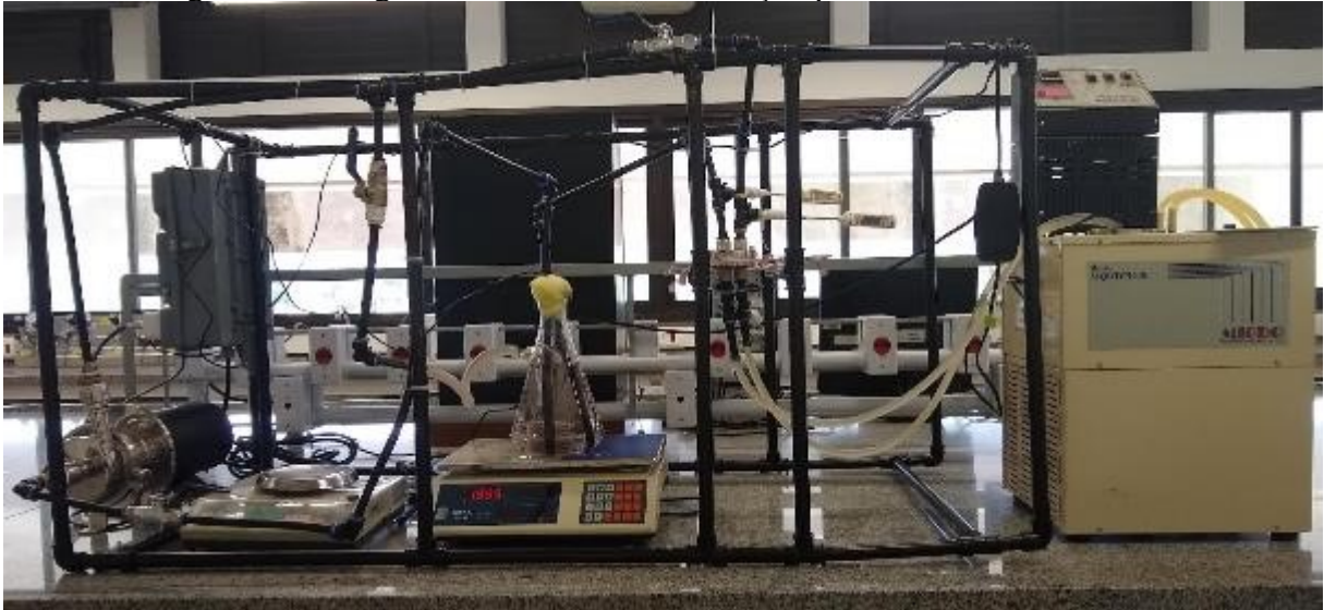
Figura 9 – Fotografia da unidade de destilação por membranas utilizada.
