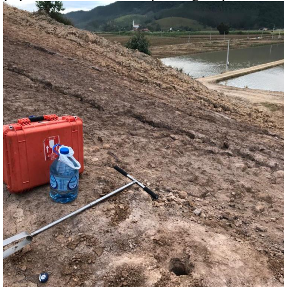
Figura 20 - Equipamento BST e trado pedológico para execução do ensaio.
