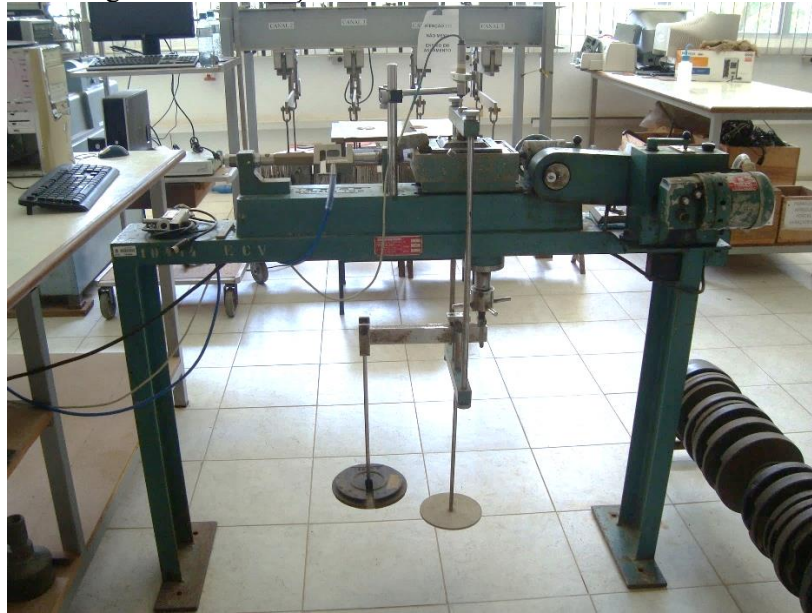
Figura 44 - Execução do ensaio de Cisalhamento Direto.
