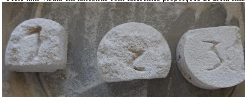
Figura 41 - Teste tátil-visual em amostras com diferentes proporções de areia fina, cal e água.
