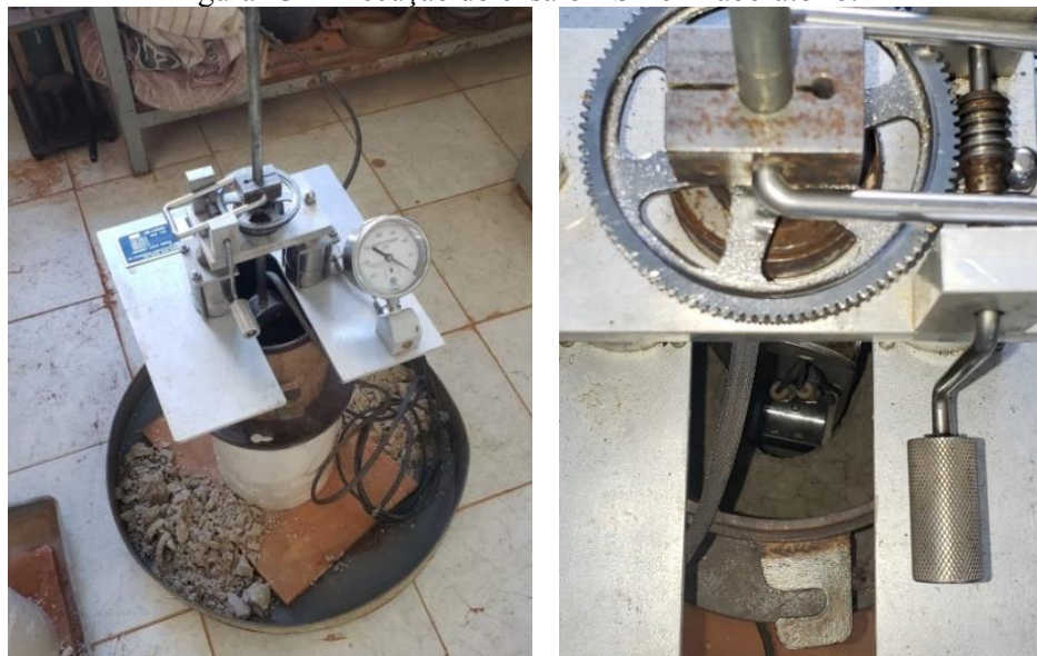
Figura 43 - Execução do ensaio BST em laboratório.
