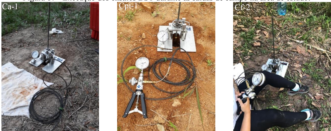
Figura 87 - Execução dos ensaios BST durante as saídas de campo na área de estudo.
