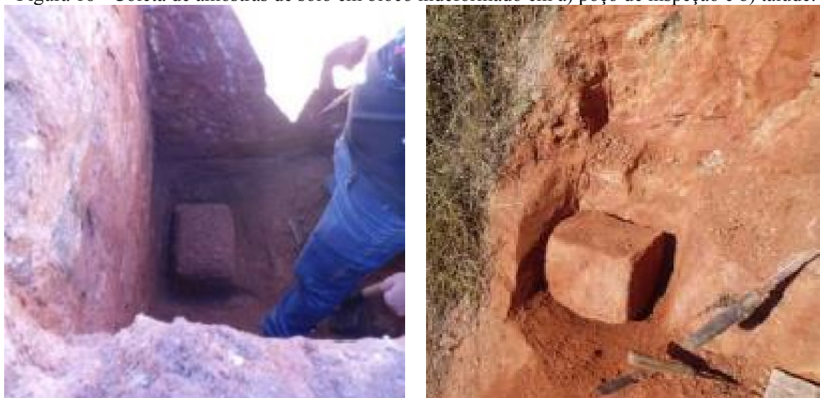
Figura 18 - Coleta de amostras de solo em bloco indeformado em a) poço de inspeção e b) talude.
