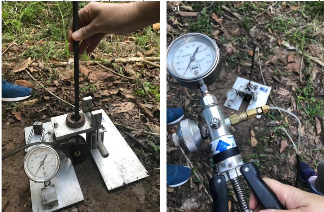
Figura 48 - Motagem do equipamento (a) e execução do ensaio BST na área de estudo (b).
