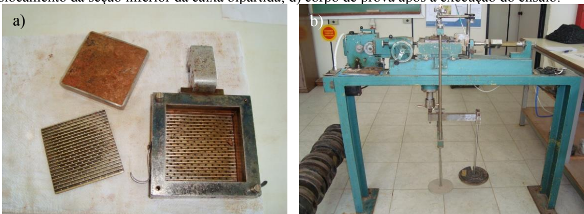
Figura 10 - Ensaio de Cisalhamento Direto: a) montagem da caixa bipartida e corpo de prova; b) equipamento utilizado no ensaio; c) detalhe da aplicação da tensão cisalhante resultando no deslocamento da seção inferior da caixa bipartida; d) corpo de prova após a execução do ensaio.
