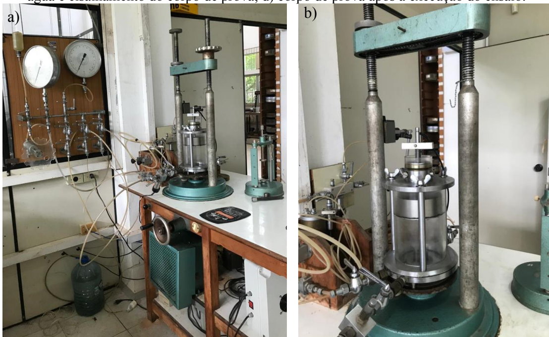
Figura 14 - Ensaio de Compressão Triaxial: a) equipamento; b) câmara; c) câmara preenchida com água e cisalhamento do corpo de prova; d) corpo de prova após a execução do ensaio.
