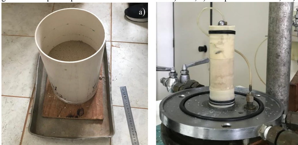
Figura 42 - Corpos de prova utilizados nos ensaios: a) BST; b) Compressão Triaxial; e c) CD.
