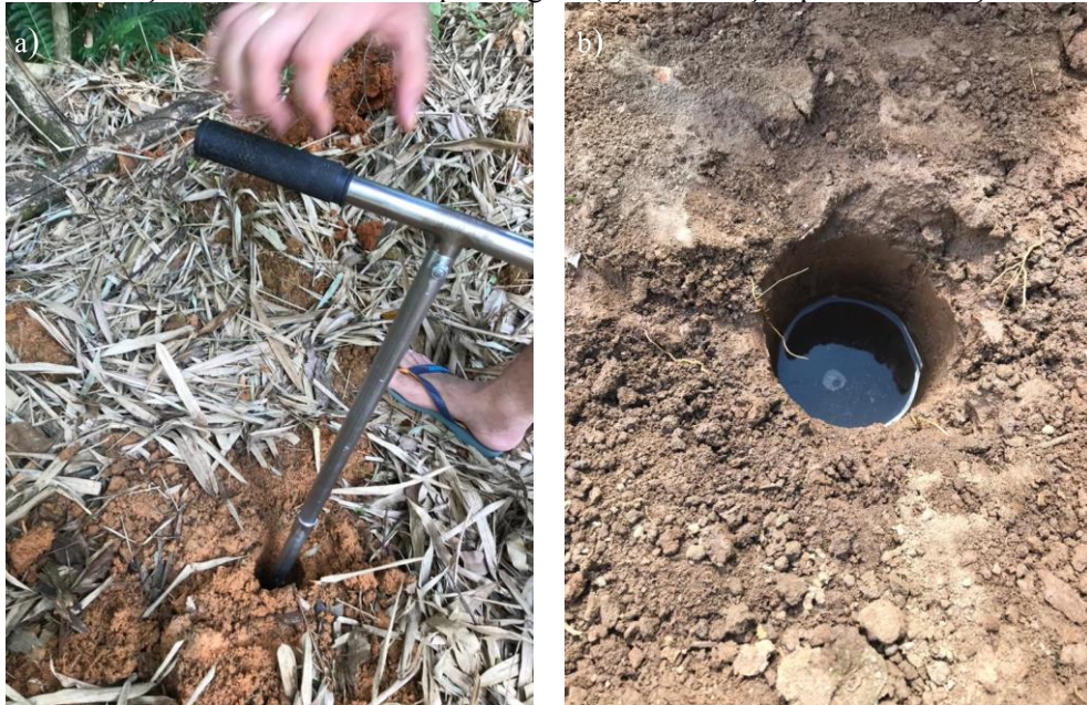
Figura 47 - Realização do furo com trado pedológico (a) e inundação para a realização do ensaio (b).
