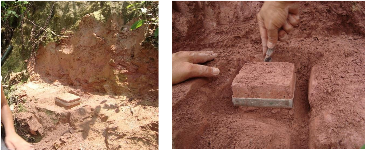
Figura 19 - Coleta de amostras de solo no molde do ensaio de Cisalhamento Direto em taludes.
