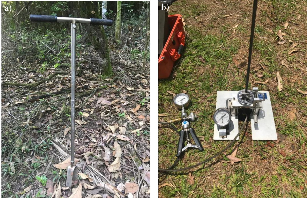
Figura 17 - Ensaio BST: a) trado pedológico; b) montagem do equipamento, modelo A103.
