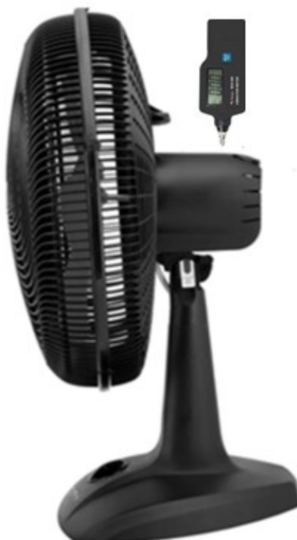
Figura 14 – Ventilador com medidor de vibração.
