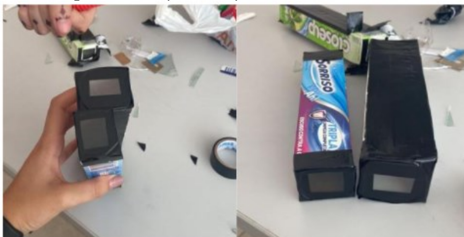
Figura 135 - Espectroscópio caseiro confeccionado
