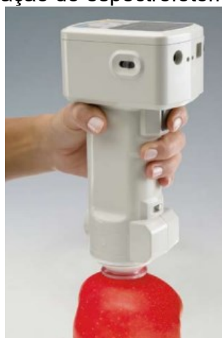
Figura 111 – Utilização do espectrofotômetro em uma maçã
