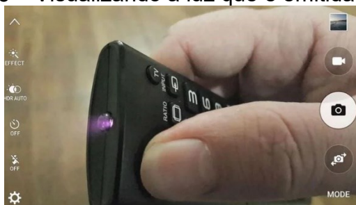
Figura 55 - Figura 55 – Visualizando a luz que é emitida pelo controle remoto
