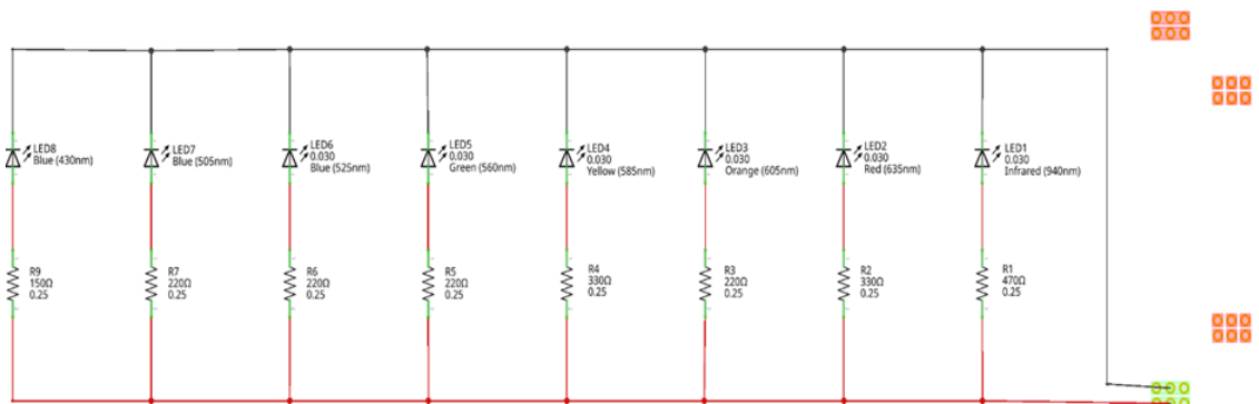
Figura 34 - Diagrama eletrônico do circuito - Projeto 05: dedução da cor emitida pelo LED
