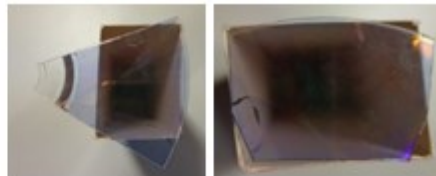
Figura 107 - Adicionando a lente difrativa a estrutura do espectroscópio
