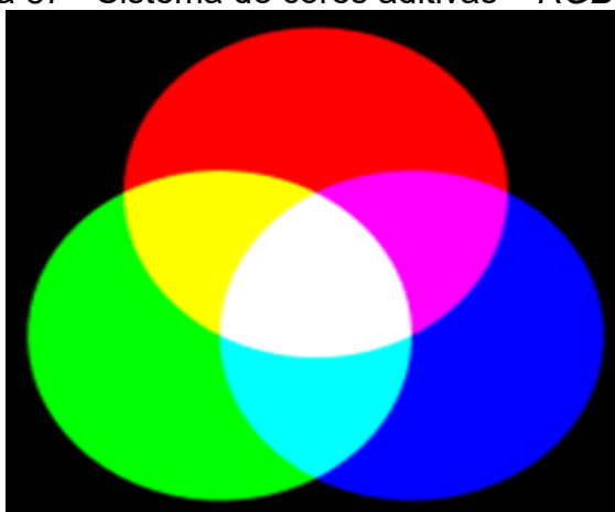
Figura 87 - Sistema de cores aditivas – RGB
