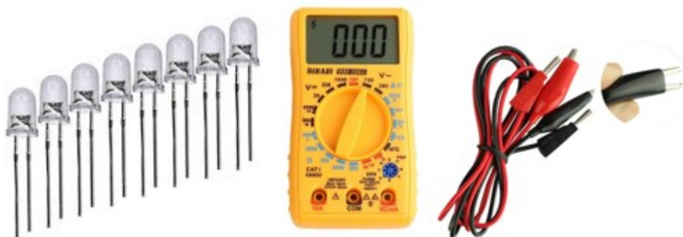
Figura 95 - LEDs transparentes de 5 mm, o multímetro e um par de cabos de conexão banana/jacaré
