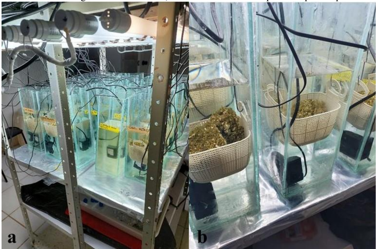
Figura 3 – Estrutura preparada para o experimento. Mesa construída para controlar parâmetros como temperatura, salinidade e incidência de luz (a). Agregados posicionados dentro de caixas plásticas vazadas (b). Na parte inferior dos aquários, foram posicionados os circuladores de água e os termômetros, ambos conectados a um painel na parte superior.
