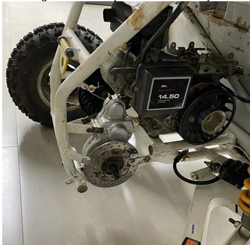
Figura 5 - Orientação da caixa de redução
