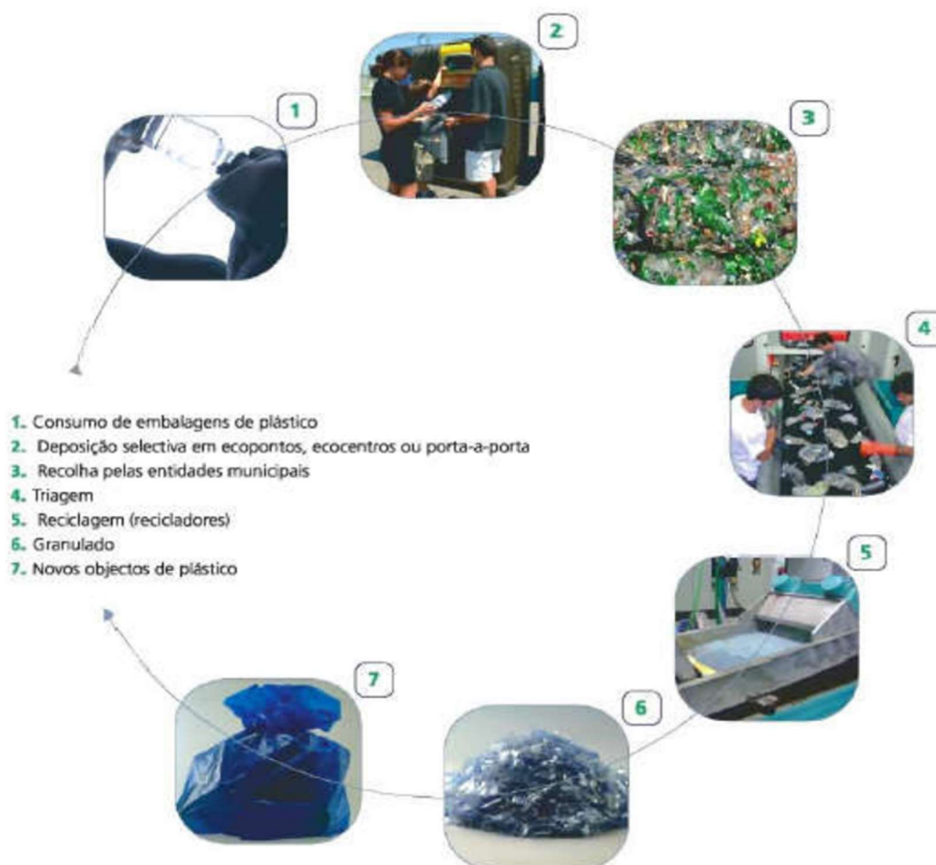
Figura 8 – Etapas da reciclagem mecânica do plástico
