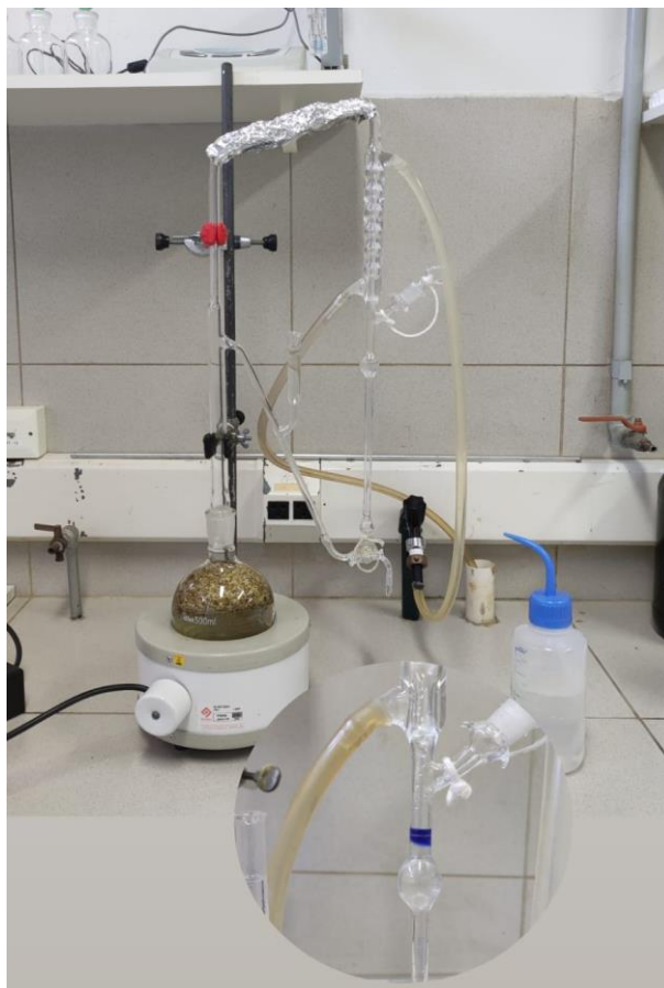
Figura 9 - Processo de hidrodestilação realizado com aparato Clevenger
