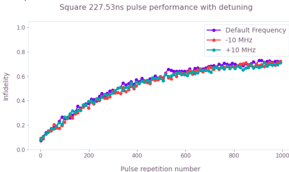
Figure 11. Infidelidade do pulso square de 227.33 \text{ ns} aplicado na frequência padrão, com -10 \text{ MHz} e +10 \text{ MHz} .
