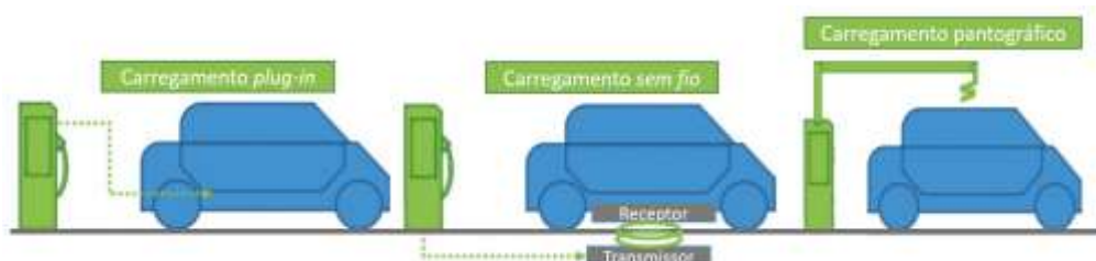
Figura 3 - Tipos de carregamento de VEs.
