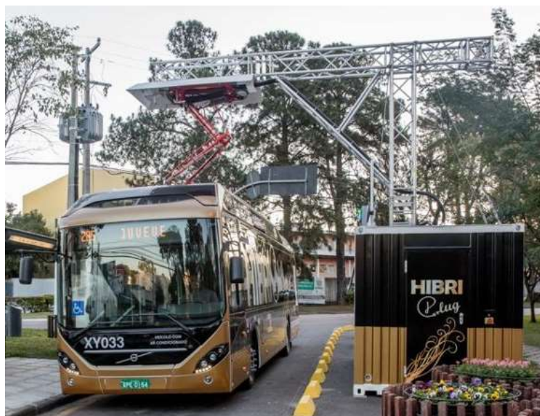
Figura 4 - Ônibus Elétrico durante carregamento pantográfico em Curitiba, PR.
