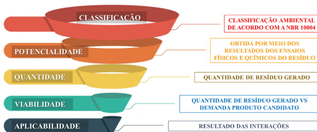
Figura 3-8 – Sistemática CPQvA adotada para análise das possíveis amostras que serão parte de misturas cimentícias.
