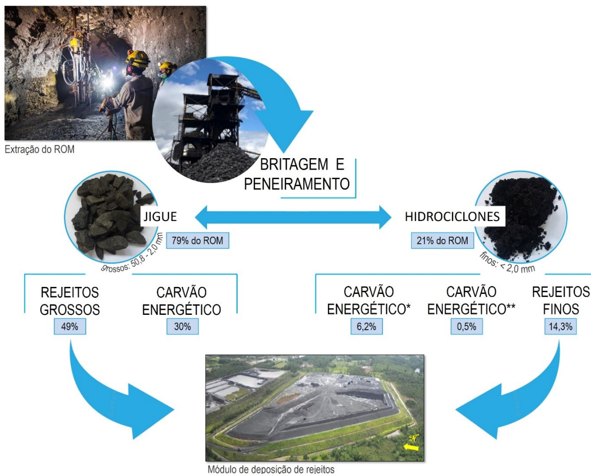
Figura 2-6 – Fluxograma de extração, circuito de beneficiamento do carvão e rejeitos típicos da região carbonífera de Santa Catarina.
