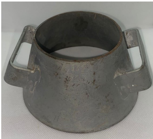
Figura 3-13 – Imagens fotográficas: (a) do molde de aço padronizado pela NBR 13276 e (b) do molde com tamanho reduzido usado neste trabalho.
