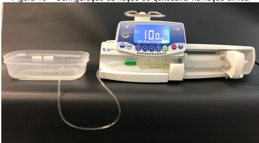
Figura 10 – Configuração da fiação de quitosana via fiação úmida
