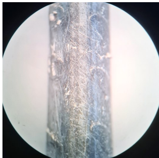
a) 0,0% NaCl – Sem corrosão aparente
