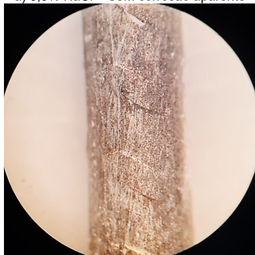
c) 0,5% NaCl – Sem corrosão aparente
