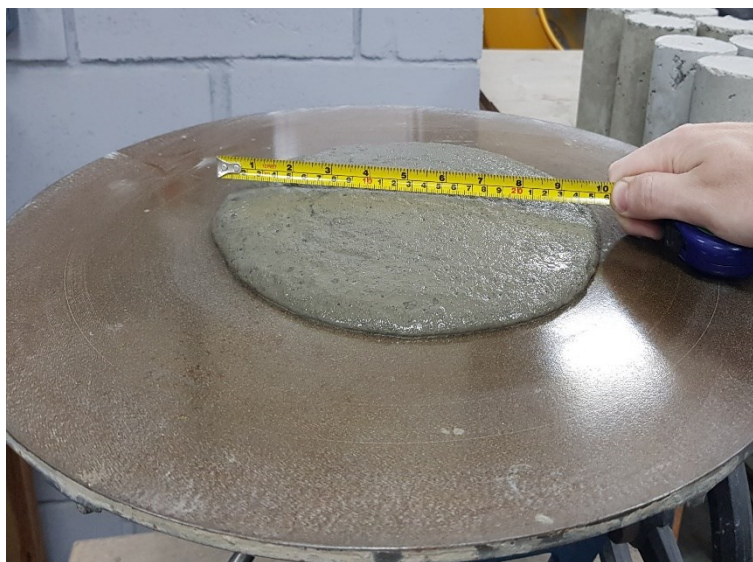
Figura 23 – Espalhamento da argamassa de cimento Portland
