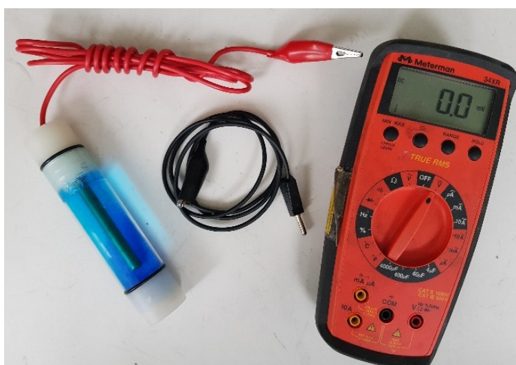
Figura 19 – Equipamentos utilizados no ensaio de potencial de corrosão
