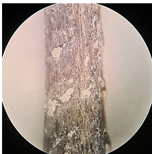
a) 0,0% NaCl – Sem corrosão aparente
