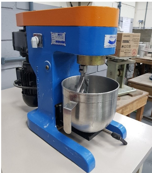
Figura 13 – Argamassadeira utilizada para a produção das amostras
