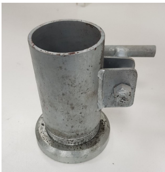
Figura 15 – Molde dos corpos de prova cilíndricos com \varnothing 50 mm e altura de 100 mm
