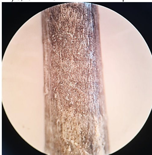
d) 0,75% NaCl – Sem corrosão aparente
