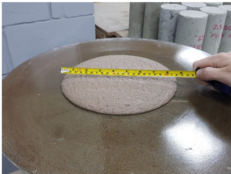
Figura 22 – Espalhamento da argamassa geopolimérica
