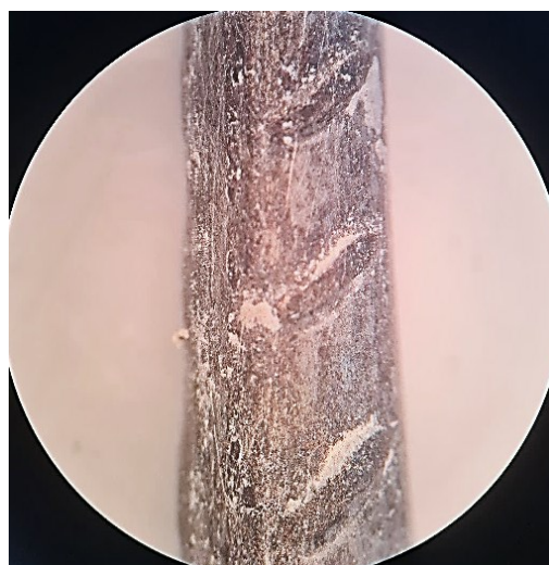
b) 0,25% NaCl – Sem corrosão aparente
