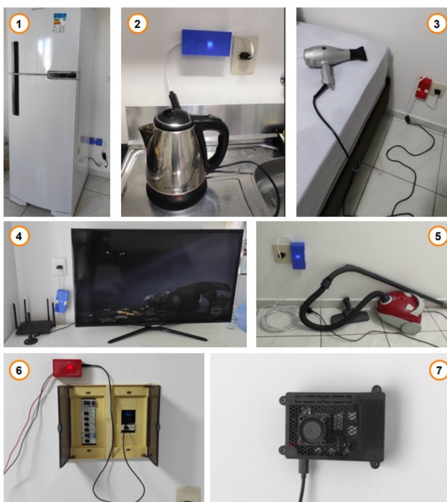
Figura 20 – Sensores e central de monitoramento instalados no ambiente
