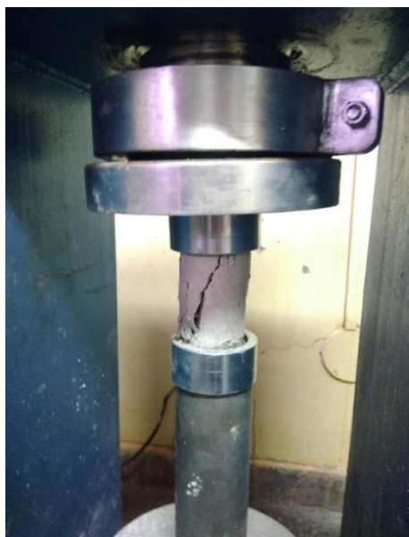
Figura 2 : Rompimento do corpo de prova em prensa automática Fonte: autor
