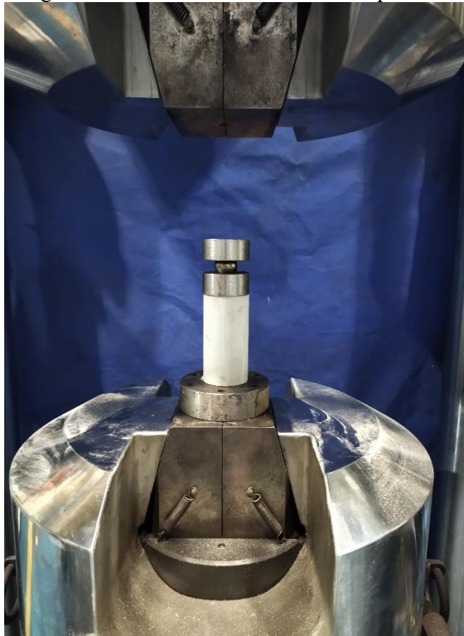
Figura 21 – Ensaio de resistência à compressão.
