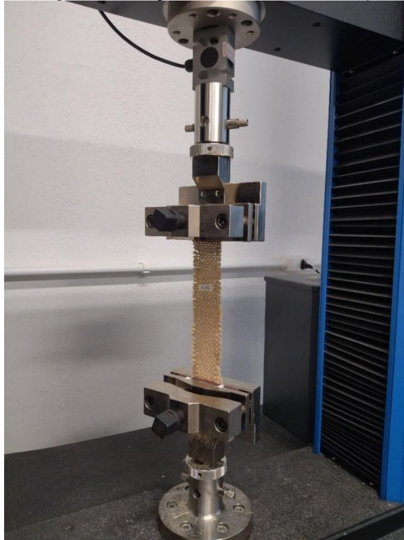
Figura 19 – Máquina universal para ensaios de resistência à tração de tecidos.
