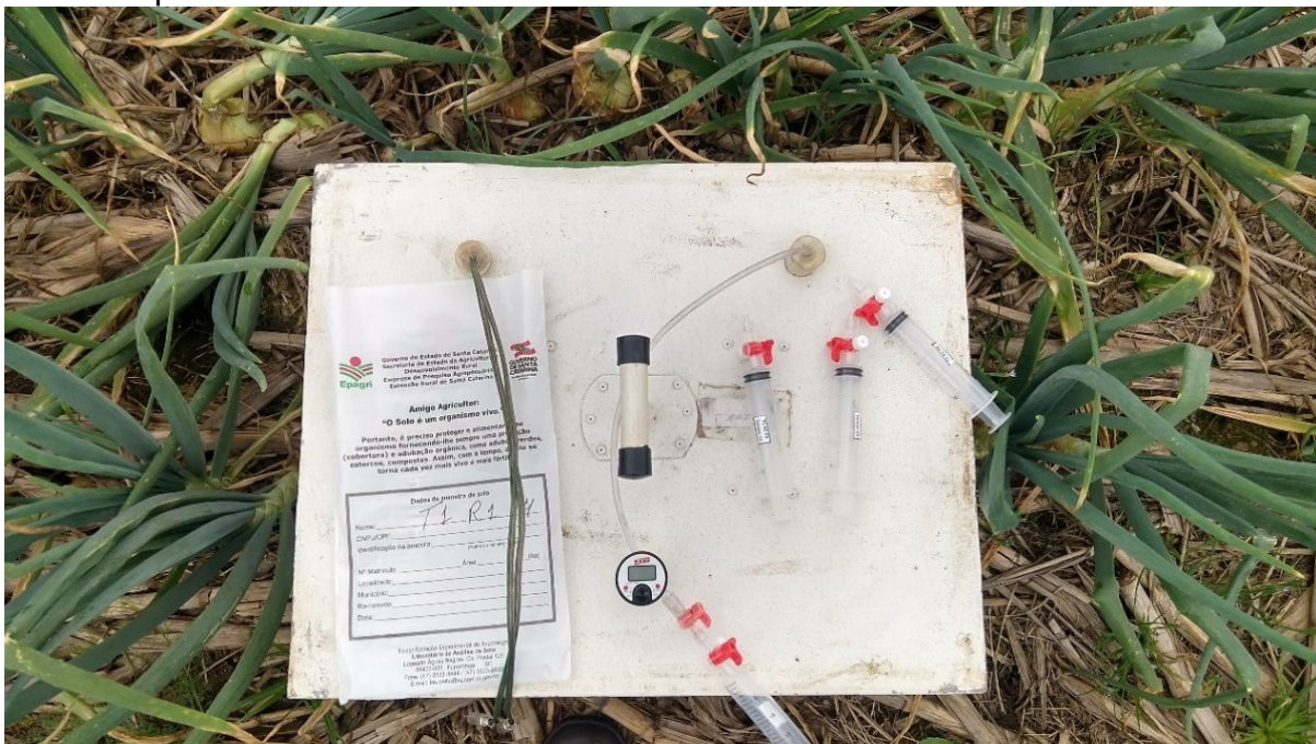
Figura 4: Modelo de câmaras estáticas utilizadas na coleta das amostras de GEE e seus compartimentos.
