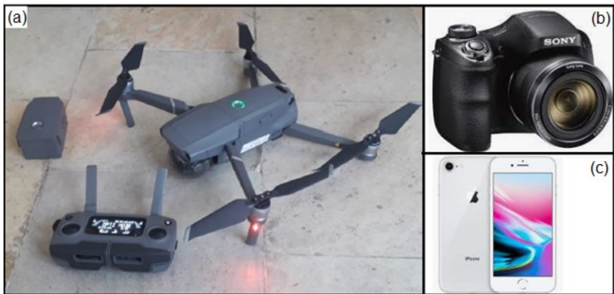
Figura 20 - Equipamentos utilizados no levantamento de dados e para a geração do modelo tridimensional pela técnica da fotogrametria.
