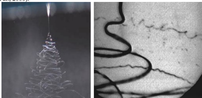
Figura 4 – (Esq.) Formação do cone de Taylor, seguida pelo segmento reto do jato e pela zona de instabilidade (Fonte: PETRIK, 2011); (Dir.) Visão aproximada do fim do segmento reto do jato (Fonte: RENEKER et al., 2000).
