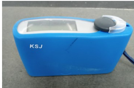
Figura 19: Fotografia mostrando o equipamento utilizado para medir o brilho ( Glossmeter ).
