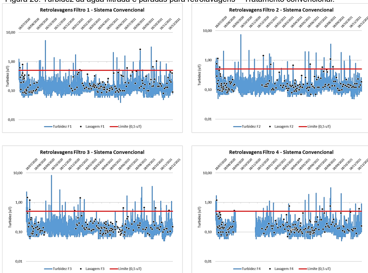
Figura 26. Turbidez da água filtrada e paradas para retrolavagens – Tratamento convencional.
