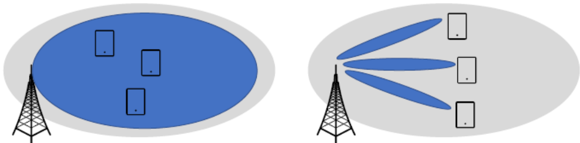
Figura 8 – Single beam , na esquerda, e multi beam , na direita
