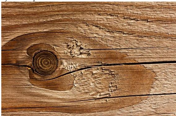
b) Nó provocando inclinação nas fibras – desvio do fio
