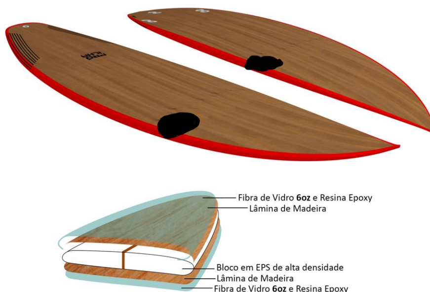
Figura 7 - Estrutura de uma prancha de surfe
