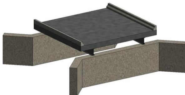
**Figura 32 - Ponte mista aço/concreto. Fonte: elaborado pelos autores.**
