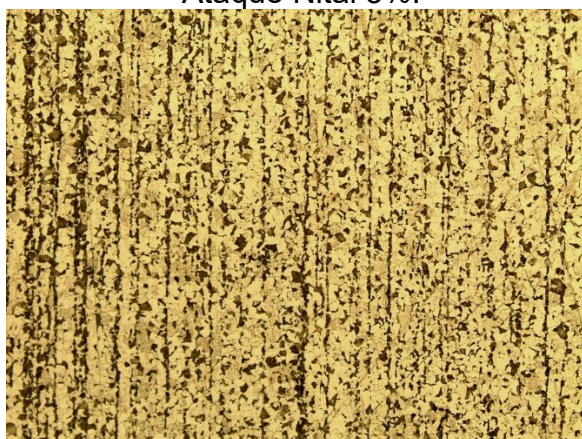
Figura 43. Metalografia do núcleo. Amostra 2M (2). Aumento 100x. Ataque Nital 3%.
