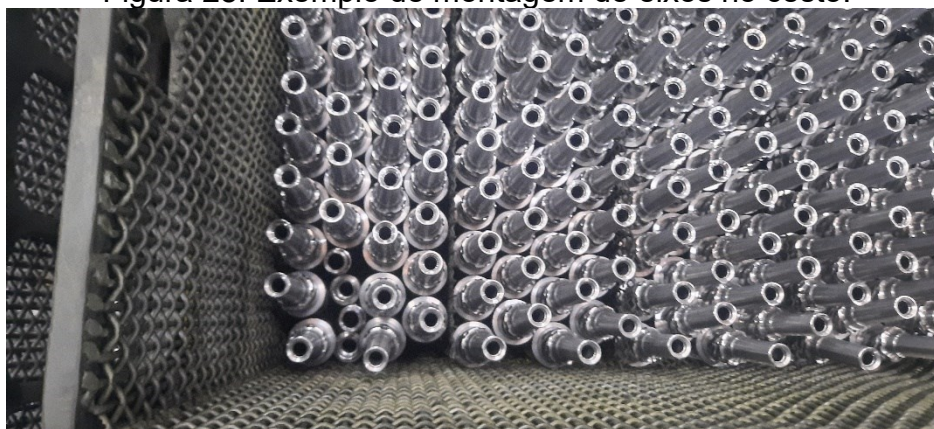
Figura 28. Exemplo de montagem de eixos no cesto.
