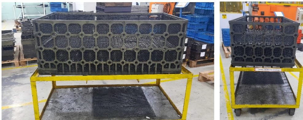
Figura 27. Vista do cesto utilizado para tratamento das cargas no tratamento térmico.
