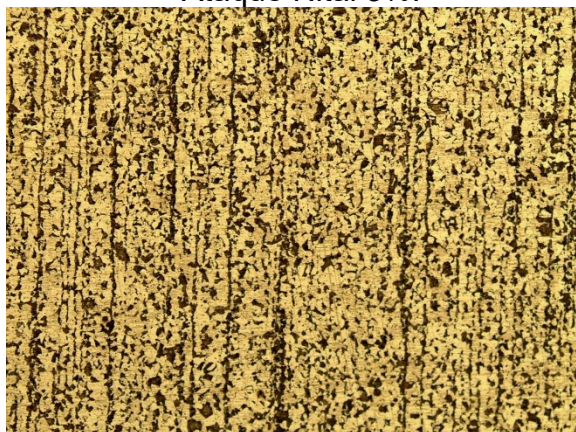
Figura 39. Metalografia do núcleo. Amostra 1M (2). Aumento 100x. Ataque Nital 3%.
