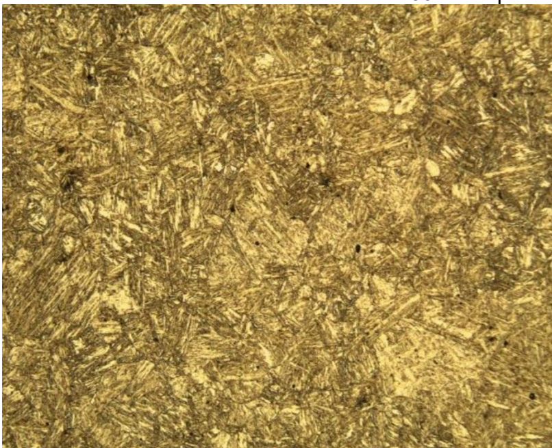
Figura 71. Microestrutura do núcleo. Aumento: 200x. Ataque: nital 3%.
