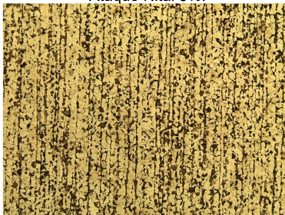
Figura 45. Metalografia do núcleo. Amostra 3M (1). Aumento 100x. Ataque Nital 3%.
