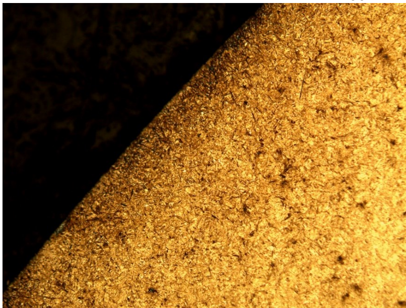
Figura 70. Microestrutura da camada cementada. Aumento: 200x. Ataque: nital 3%.
