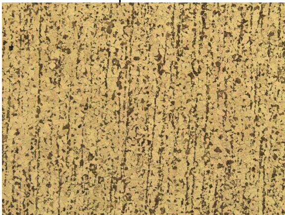
Figura 51. Metalografia do núcleo. Amostra 3M (4). Aumento 100x. Ataque Nital 3%.
