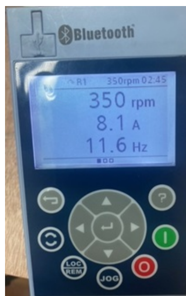
Figura 88 – Corrente de saída do inversor durante o teste - 2.
