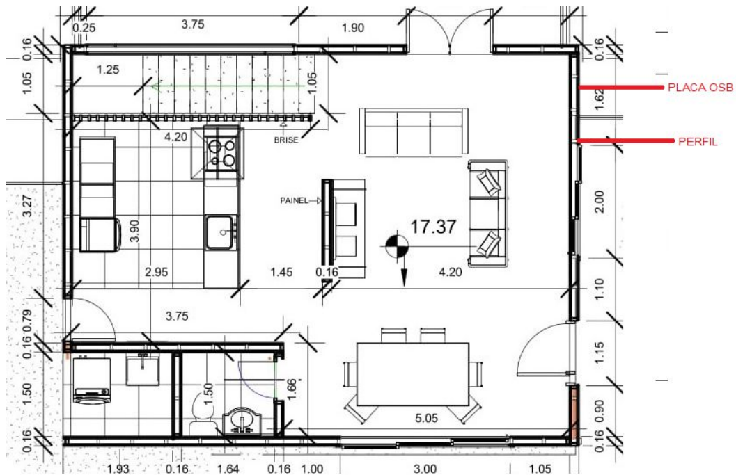
Figura 11: Detalhe da representação técnica do projeto executivo Wood frame gerado no Revit®-. Fonte: elaborado pelos autores, 2018.
