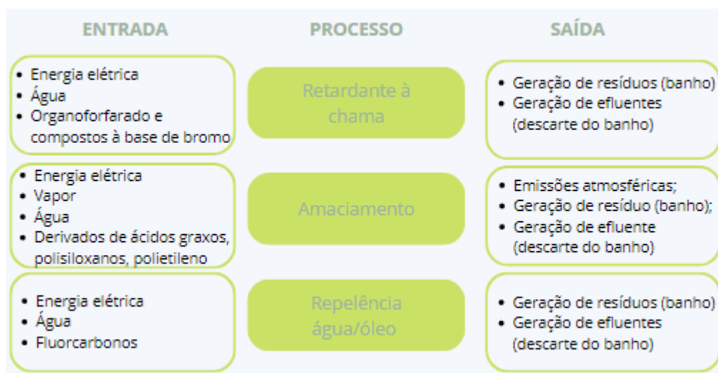
Figura 9 - Entradas e saídas dos principais processos de acabamento têxtil.
