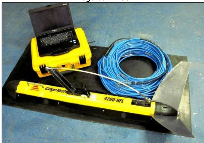
Figura 11 – Equipamento sonar de varredura lateral ( Side Scan Sonar ), modelo Edgetech 4200 .
