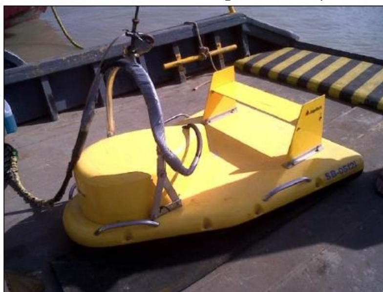
Figura 12 – Perfilador sísmico modelo EdgeTech Full Spectrum chirp 512i .
