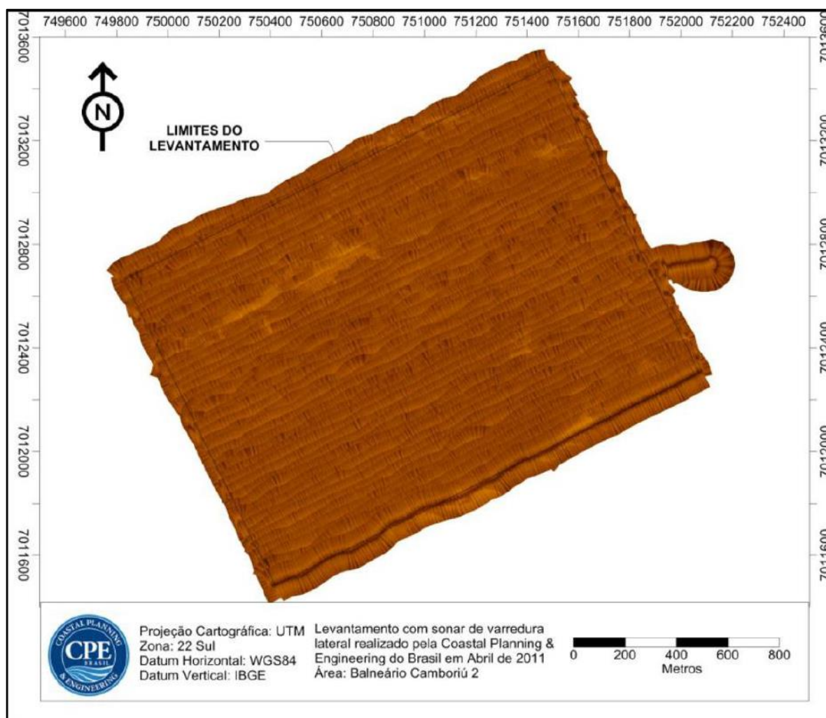
Figura 7 – Mosaico sonográfico gerado pela empresa CPE, em área correspondente à área utilizada como jazida.
