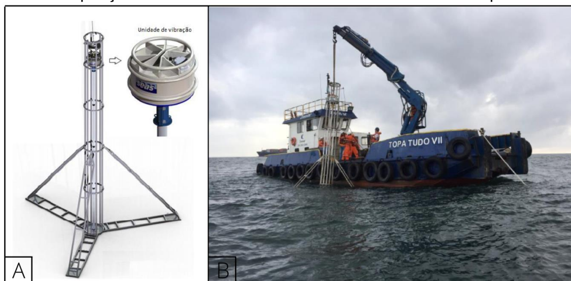
Figura 13 – (A) Equipamento Vibracore modelo SEAS VC-450 ; (B) Operação de aquisição de testemunho com o método Vibracore em campo.
