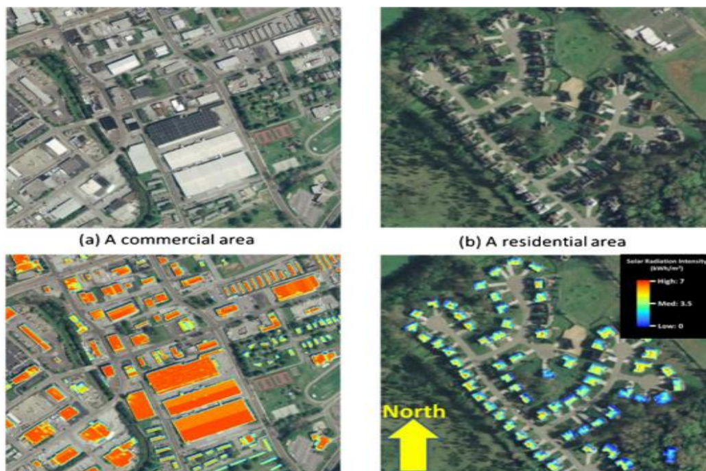
Figura 5 - Demonstrando a diferença nos valores de radiação solar entre telhados residenciais e comerciais. Fonte: Kodysh et al. (2013).
