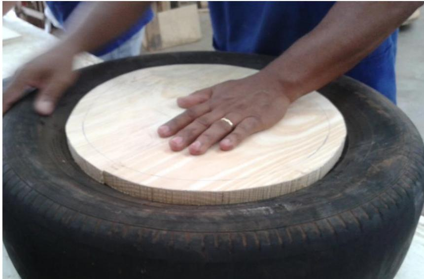
**Figura 2: Teste de tamanho após corte da base. Fonte: elaborado pelo autor.**
