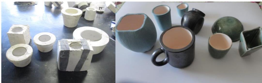
**Figura 4: À esquerda, moldes de gesso preenchidos com argila líquida. À direita, resultados do teste com acabamentos nas peças de amostra. Fonte: elaborada pelas autoras.**
