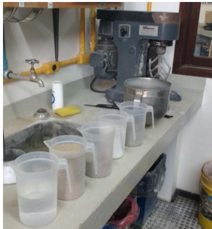
Figura 1: Recipientes com os materiais dosados e a argamassadeira
